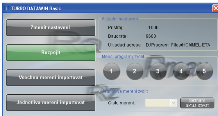
Obrázek 3-7: Import dat (příklad s přístrojem T1000)
