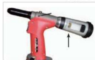
Drehregler zum Anpassen der Absaugung.
